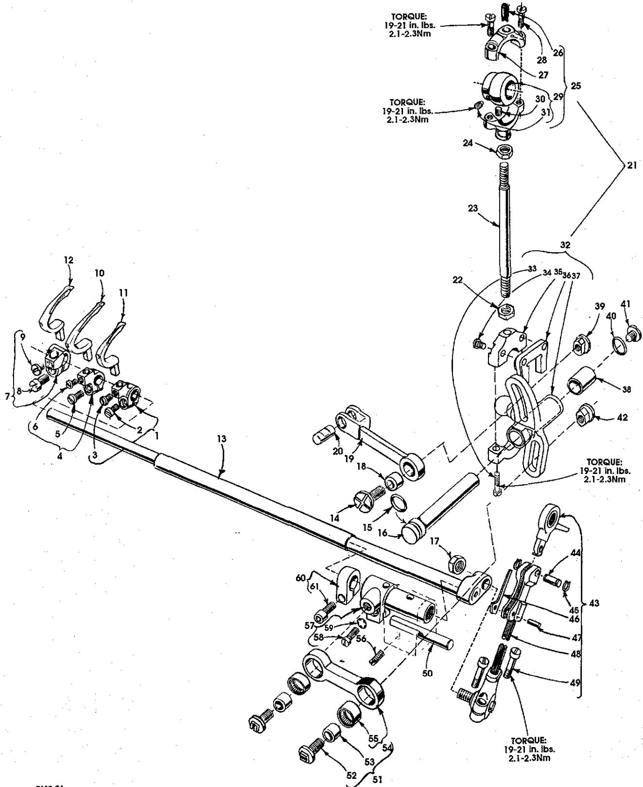
**LOOPERS, LOOPER HOLDERS, FEED DRIVE ASSEMBLY AND LOOPER AVOID ASSEMBLY (CONT.)**
